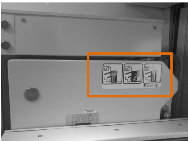
A les imatges veiem detalls de la plataforma salvaescales instal·lada a la porta del cotxe del tren adaptat de la serie 448 que feia el trajecte Barcelona - Caspe (i alhora part de servei regional a la zona de Tarragona).
